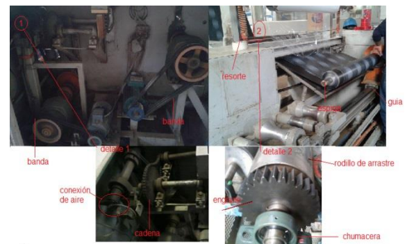
Figura 2 Partes de la enrolladora
