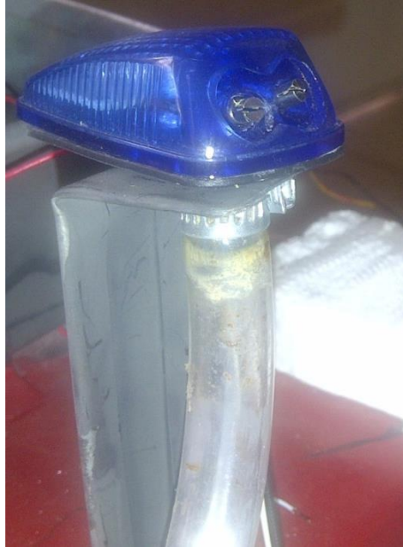
Figura 5.13. Conexión Aspersor Manguera.
