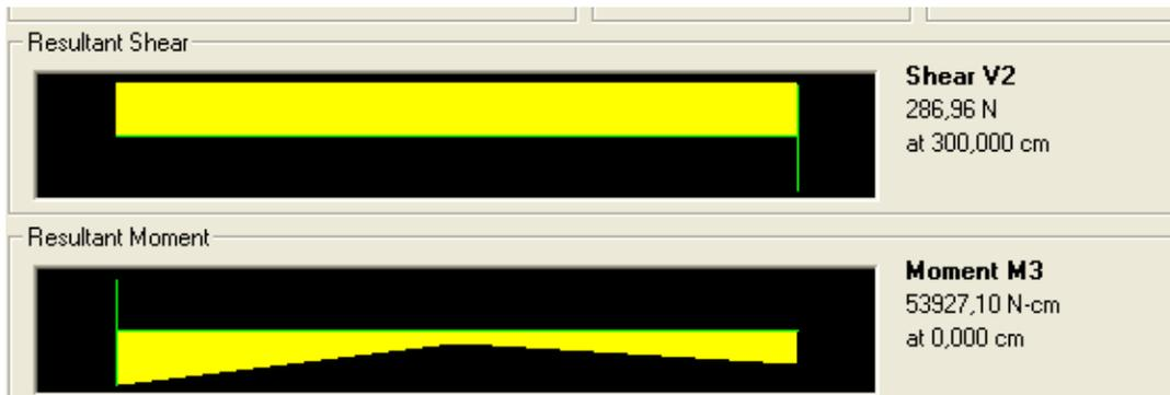
**Figura I.27** Carga espectral CEC 2000 - Fuerza cortante y momento flector elemento 2
