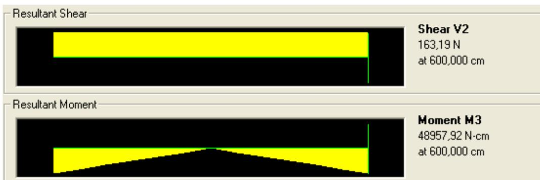
**Figura I.13** Carga espectral UBC 94 – Fuerza cortante y momento flector elemento 3
