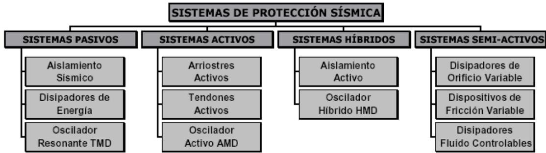
**Figura 2.42 Clasificación de los sistemas de protección sísmica \***
