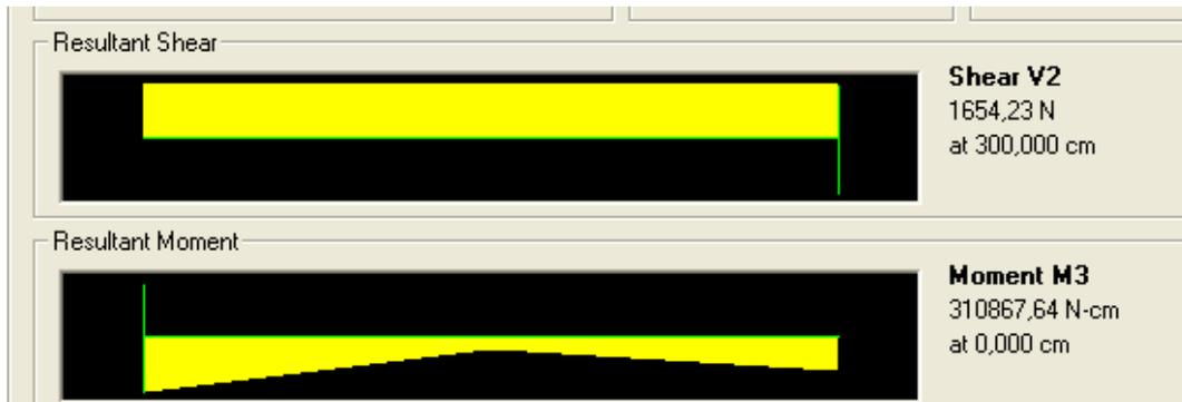
Figura I.3 Carga espectral CEC 2000 - Fuerza cortante y momento flector elemento 1
