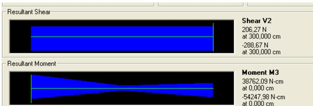
Figura I.79 Acelerograma sismo “El Centro” (Rango lineal) – Fuerza cortante y momento flector elemento 2
