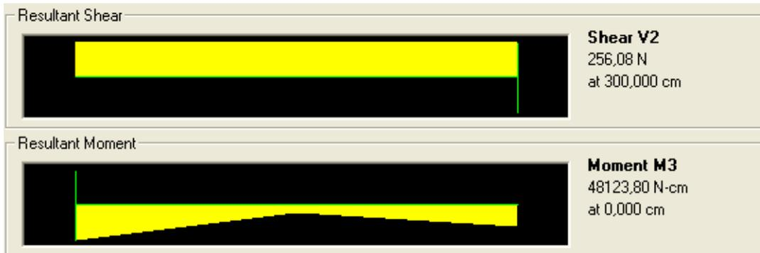
Figura I.77 Carga espectral UBC 94 – Fuerza cortante y momento flector elemento 2
