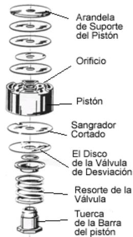
**Figura 2.15 Elementos del amortiguador\***
