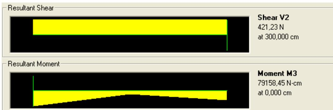
Figura I.21 Carga espectral UBC 94 – Fuerza cortante y momento flector elemento 1
