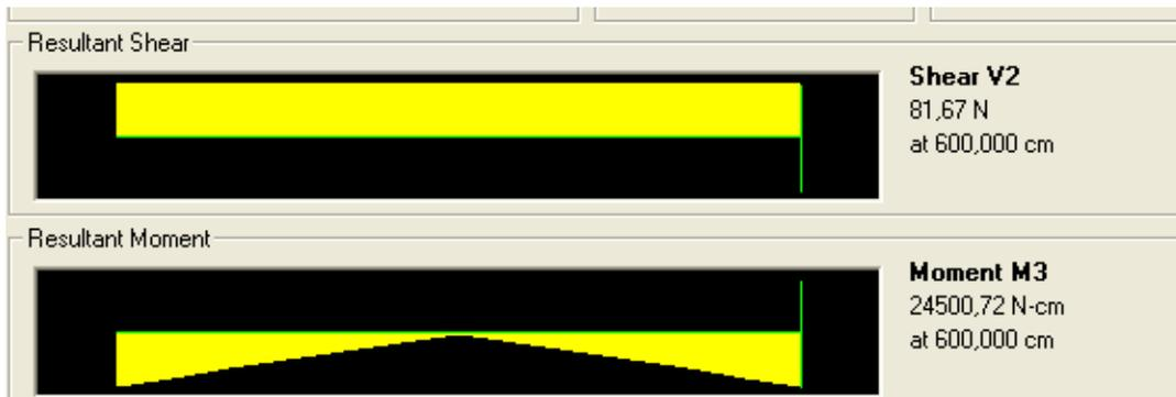
Figura I.61 Carga espectral UBC 94 – Fuerza cortante y momento flector elemento 3
