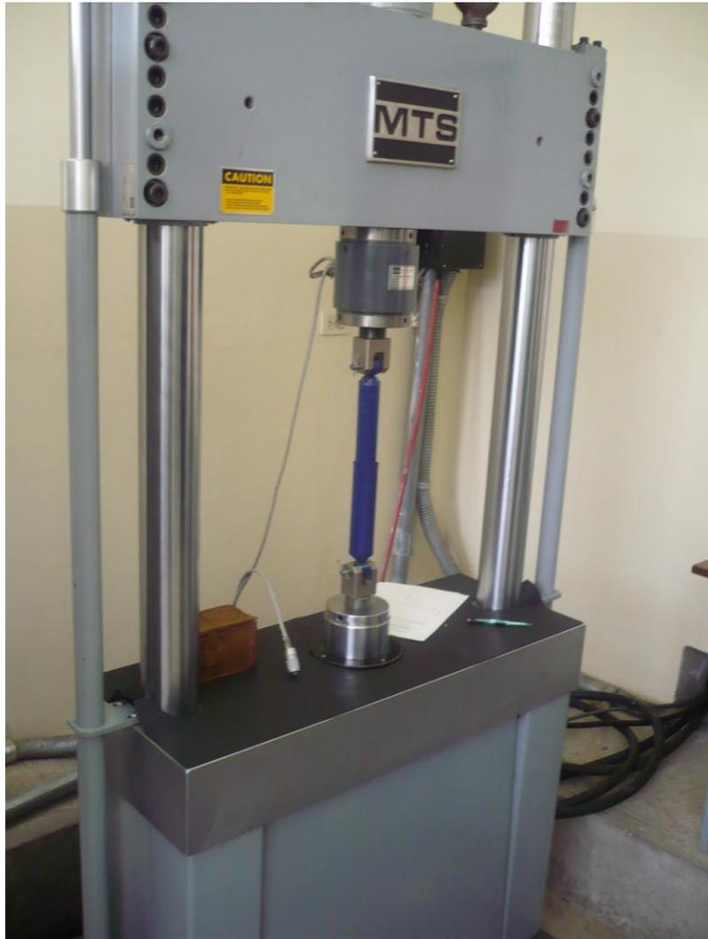
**Figura 3.6 Amortiguador instalado en la máquina**
