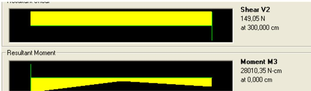
Figura I.43 Carga espectral CEC 2000 - Fuerza cortante y momento flector elemento 1
