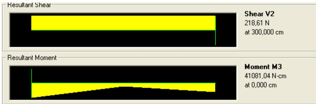
Figura I.53 Carga espectral UBC 94 – Fuerza cortante y momento flector elemento 2
