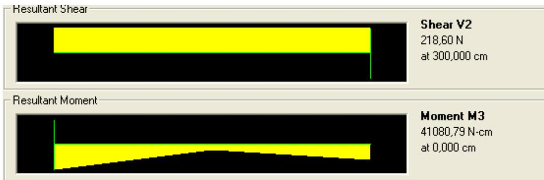
Figura I.45 Carga espectral UBC 94 – Fuerza cortante y momento flector elemento 1
