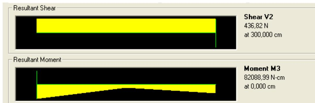
Figura I.5 Carga espectral UBC 94 – Fuerza cortante y momento flector elemento 1
