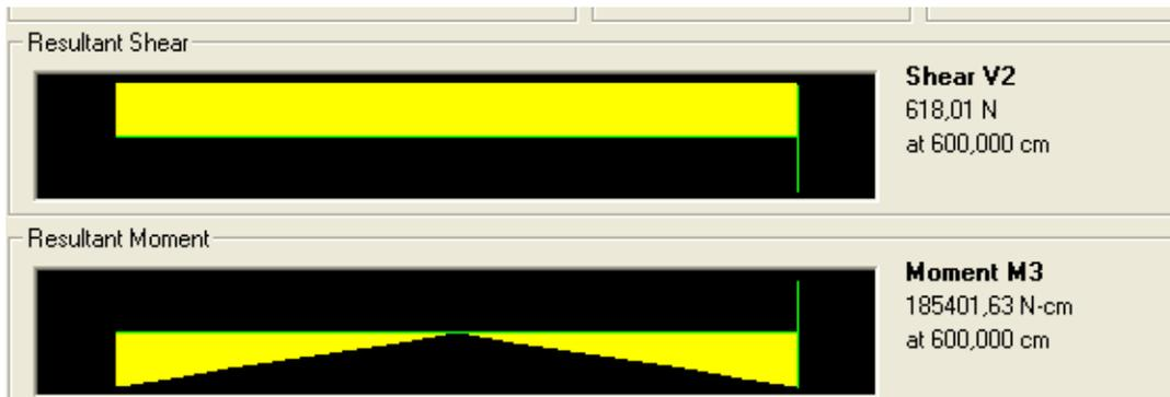
**Figura I.11** Carga espectral CEC 2000 - Fuerza cortante y momento flector elemento 3
