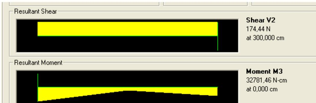
Figura I.75 Carga espectral CEC 2000 - Fuerza cortante y momento flector elemento 2
