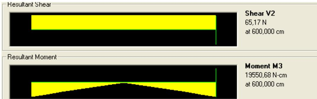
**Figura I.83** Carga espectral CEC 2000 - Fuerza cortante y momento flector elemento 3
