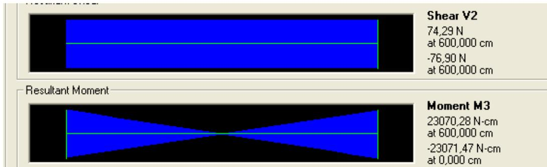
Figura I.65 Acelerograma sismo “El Centro” (Rango no - lineal) – Fuerza cortante y momento flector elemento 3
