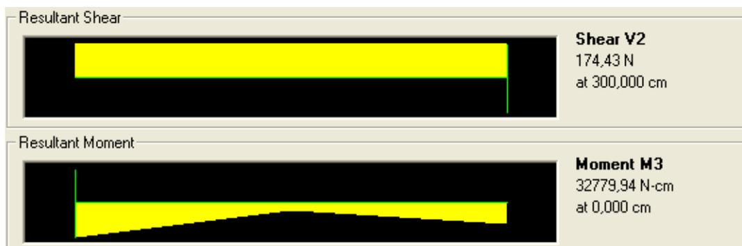
Figura I.67 Carga espectral CEC 2000 - Fuerza cortante y momento flector elemento 1
