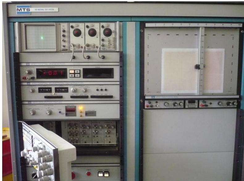
**Figura 3.3 Control de la máquina de ensayos universales**
