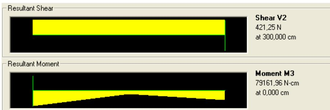
**Figura I.29** Carga espectral UBC 94 – Fuerza cortante y momento flector elemento 2
