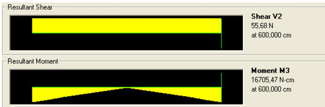
Figura I.59 Carga espectral CEC 2000 - Fuerza cortante y momento flector elemento 3
