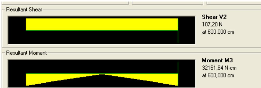
Figura I.35 Carga espectral CEC 2000 - Fuerza cortante y momento flector elemento 3
