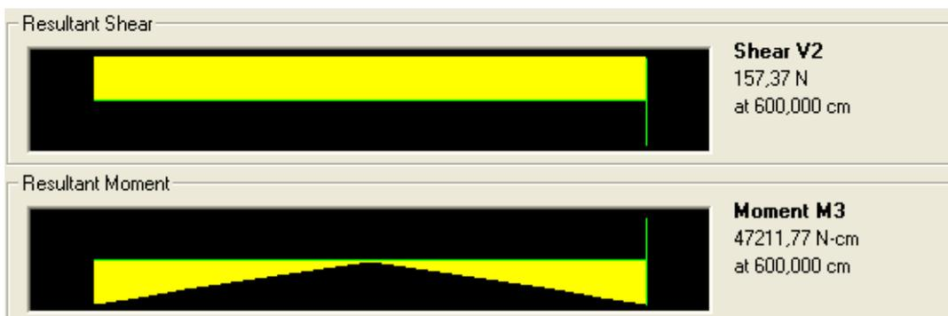
Figura I.37 Carga espectral UBC 94 – Fuerza cortante y momento flector elemento 3
