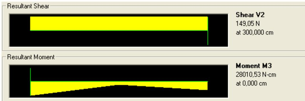
Figura I.51 Carga espectral CEC 2000 - Fuerza cortante y momento flector elemento 2
