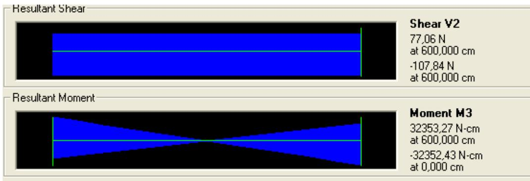
Figura I.87 Acelerograma sismo “El Centro” (Rango lineal) – Fuerza cortante y momento flector elemento 3
