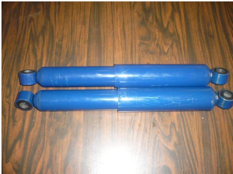
**Figura 3.1 Amortiguadores utilizados para el ensayo**
