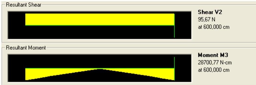
Figura I.85 Carga espectral UBC 94 – Fuerza cortante y momento flector elemento 3
