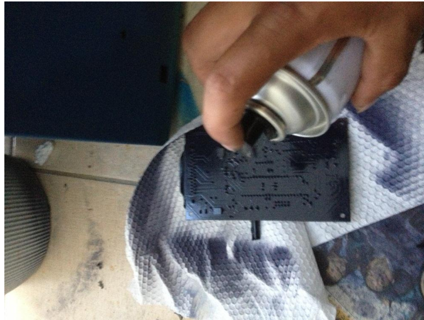
Pintura para protección de la placa
