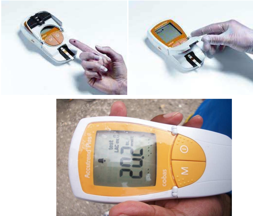
Figura 15. Colocación de la tira de lactato con la muestra de sangre en el equipo y la lectura respectiva en 60 segundos.
