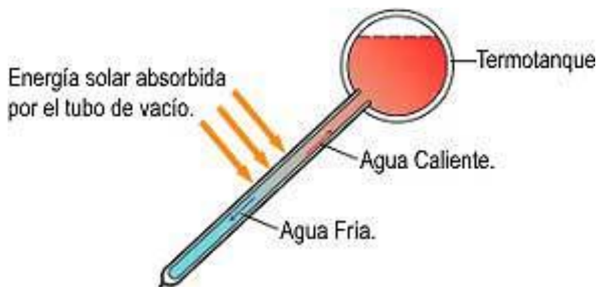
Figura 2.34 Sistema de tubos de vidrio al vacío
