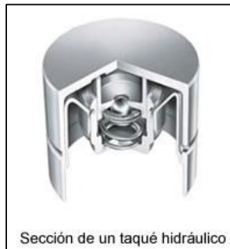
Figura 2.12: Sección de un taqué hidráulico
