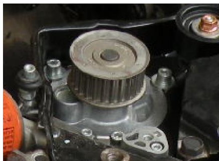
Figura 2.51: Bomba de agua
