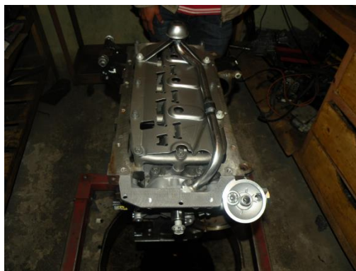
Figura 4.35: Remoción del depósito de aceite
