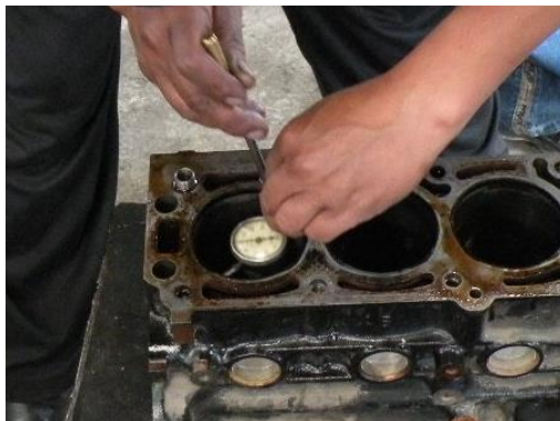
Figura 4.21: Comprobación de desgaste del cilindro
