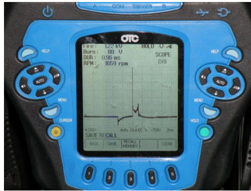
Figura 5.20: Oscilograma circuito secundario de ignición
