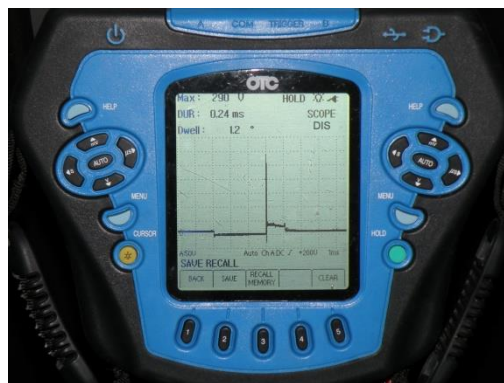
Figura 5.19: Oscilograma circuito primario de ignición
