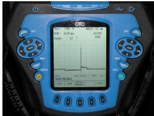
Figura 4.7: Oscilograma del sistema de encendido primario
