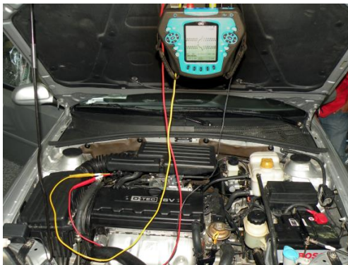
Figura 3: Osciloscopio conectado a los inyectores
