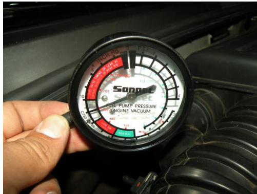
Figura 4.46: Medición final de vacío
