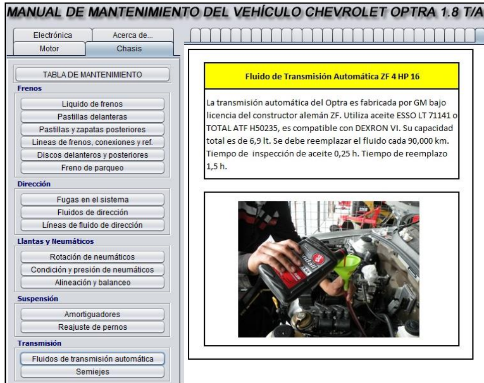
Figura 5.27: Procedimiento mecánico del manual de mantenimiento
