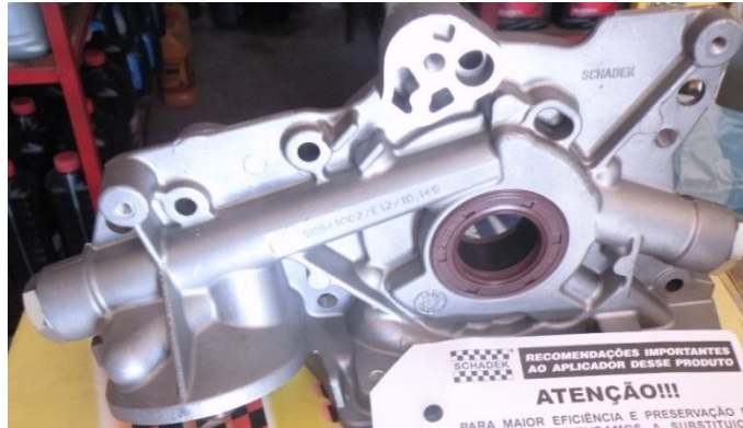
Figura 2.43: Bomba de aceite Opra
