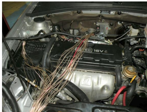
Figura 4.3: Cableado de los módulos generadores de fallas
