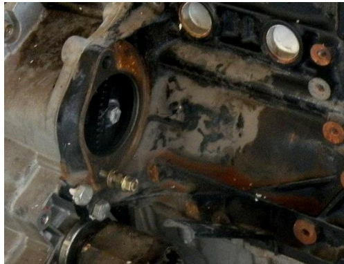
Figura 4.26: Vista de pernos del convertidor de par a través de alojamiento del motor de arranque
