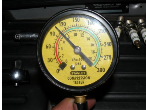
Figura 4.45: Medición final de presión de compresión
