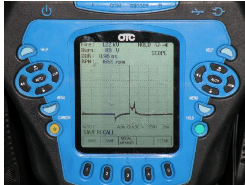
Figura 4.8: Oscilograma del sistema de encendido secundario
