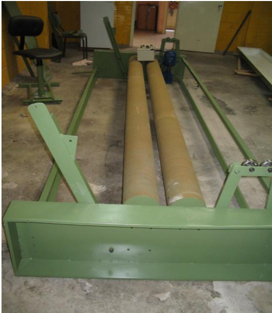
Fig. 4.4 montaje de soporte posterior y motor
