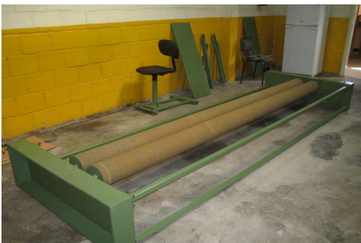
Fig. 4.3 montaje de la base principal y rodillos
