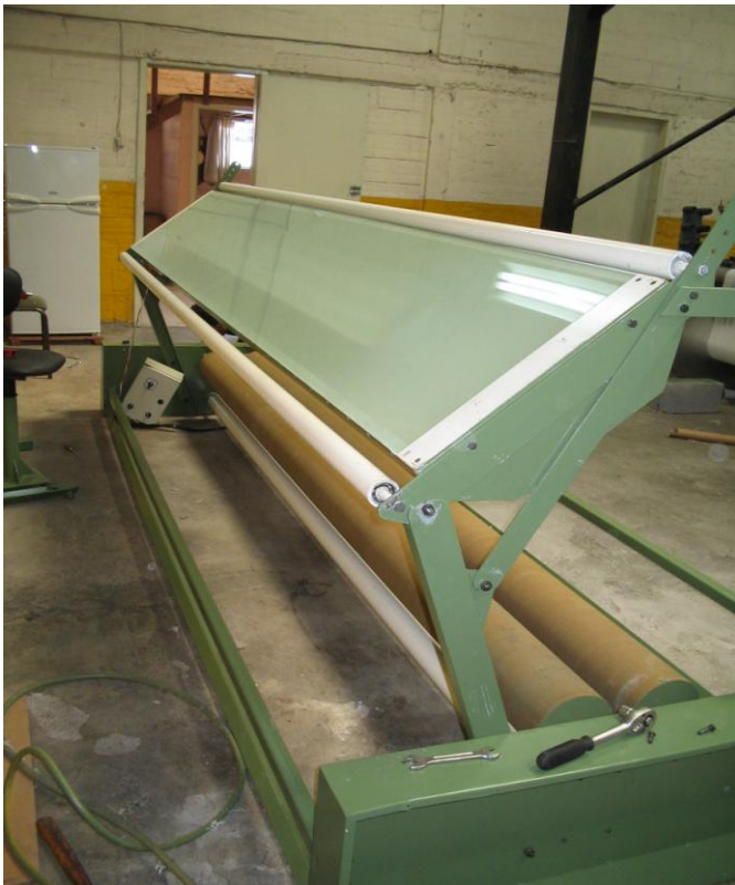
Fig. 4.9 Colocación del vidrio en el tablero de revisión
