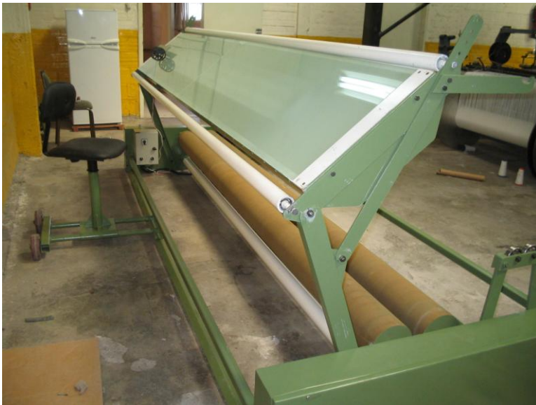
Fig. 4.11 Maquina Revisadora, Medidora y Enrolladora de tela
