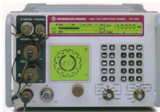
Figura 2.15 Direction Finder Doppler para uso portátil en el rango de frecuencias desde 20 MHz hasta 1000 MHz
