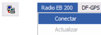
Figura III.5 Conexión con la Radio R&S EB 200
