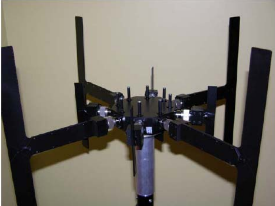
Figura 4.6 Arreglo de Antenas del DF-ALMOS 3000 para operar en el rango de 20 MHz a 3 GHz
