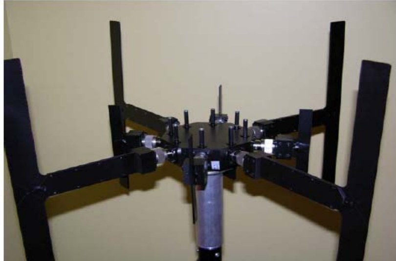
Figura 7.8 Antena de VHF utilizada en práctica de RDF
