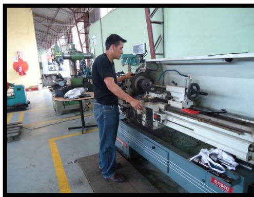
Figura 3. 27 Construcción de los Ejes.
