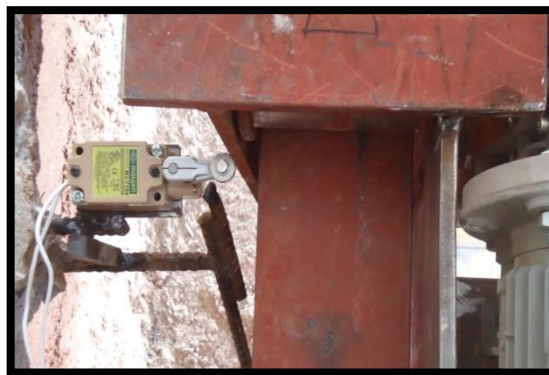
Figura 3. 41 Final de carrera accionado por el carrete del rodillo.
