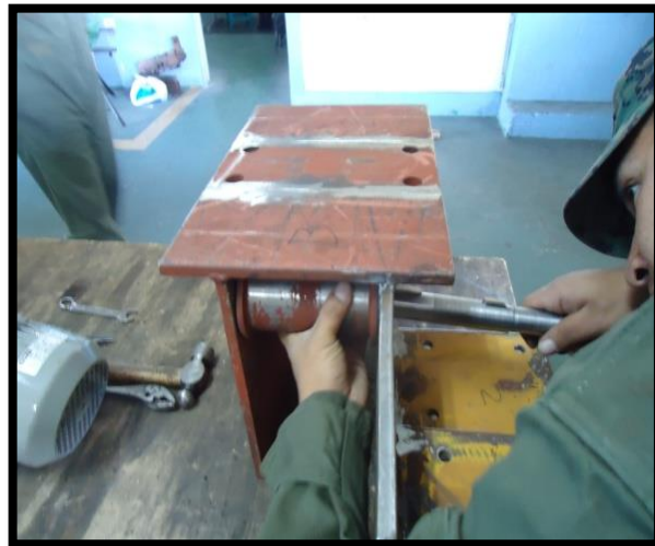
Figura 3. 35 Acoplamiento del eje, rodillo y testero.
