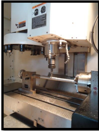
Figura 3. 28 Elaboración de los Chaveteros
