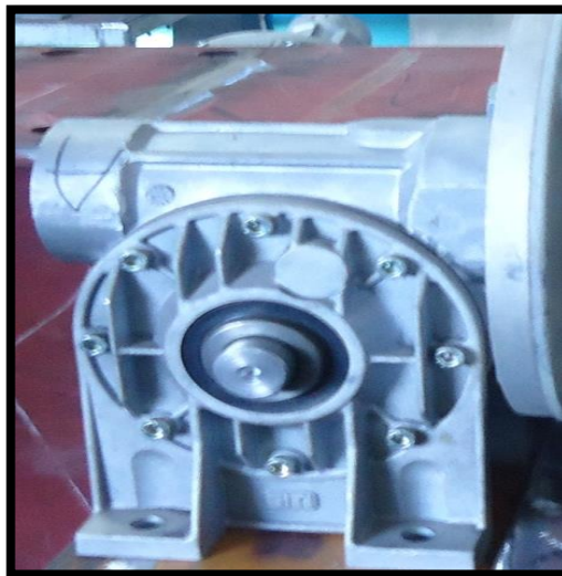
Figura 3. 7 Reductor de velocidad SITI.
