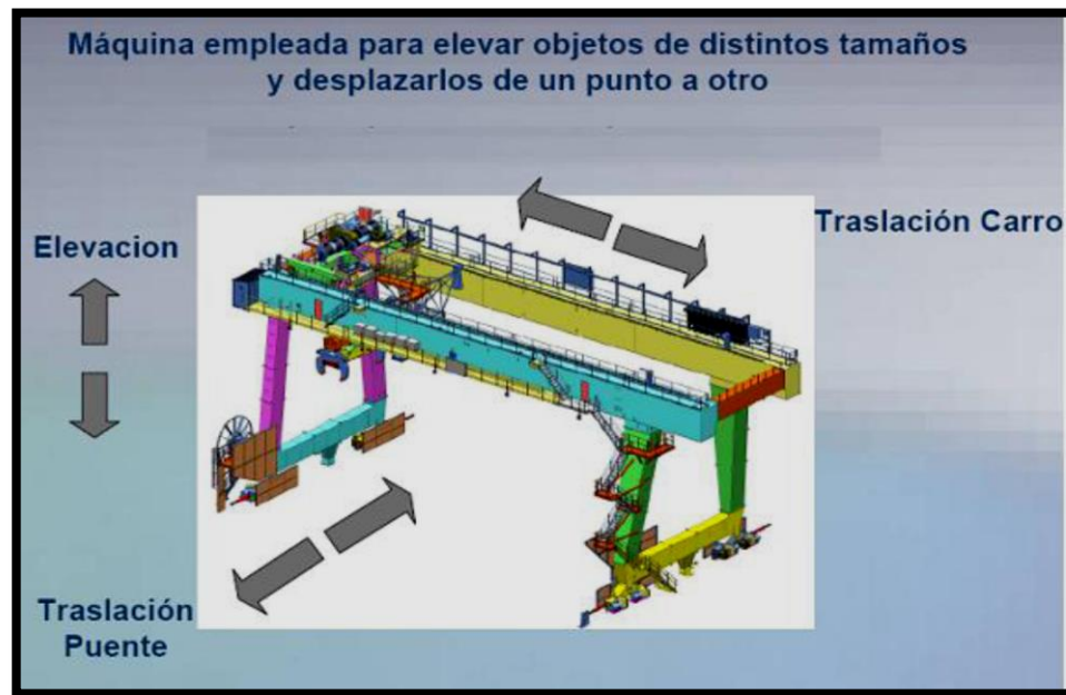
Figura 2. 5 Descripción de un Puente Grúa.
