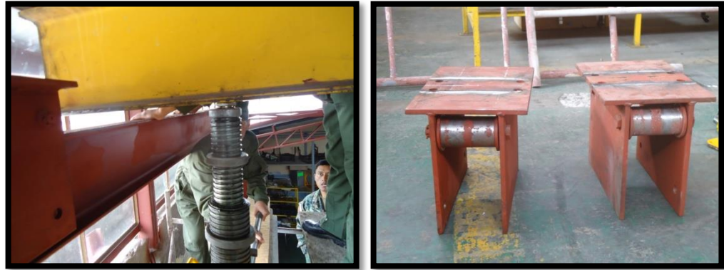
Figura 3. 19 Desmontaje de Testeros para Rediseño.
