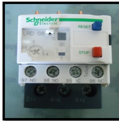
Figura 3. 12 Relé térmico Schneider.
