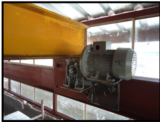
Figura 3. 38 Testero acoplado con la viga.
