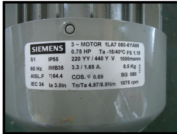
Figura 3. 6 Características del motor.
