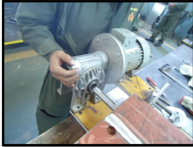
Figura 3. 36 Acoplamiento de los motorreductores.
