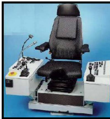
Figura 2. 21 Mando desde la Cabina.
