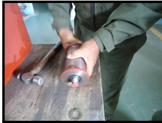
Figura 3. 20 Desmontaje total del testero.
