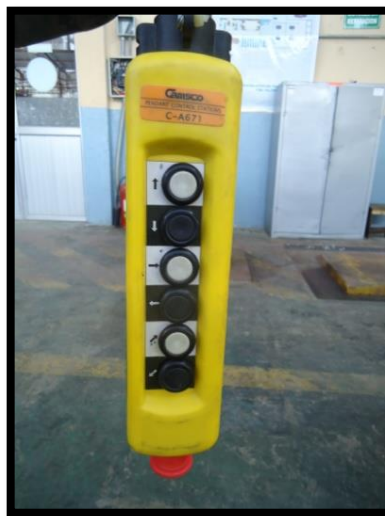
Figura 3. 17 Botonera Camsco de 6 servicios y paro de emergencia.
