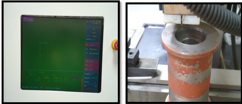
Figura 3. 32 Elaboración del chavetero interno del rodillo.
