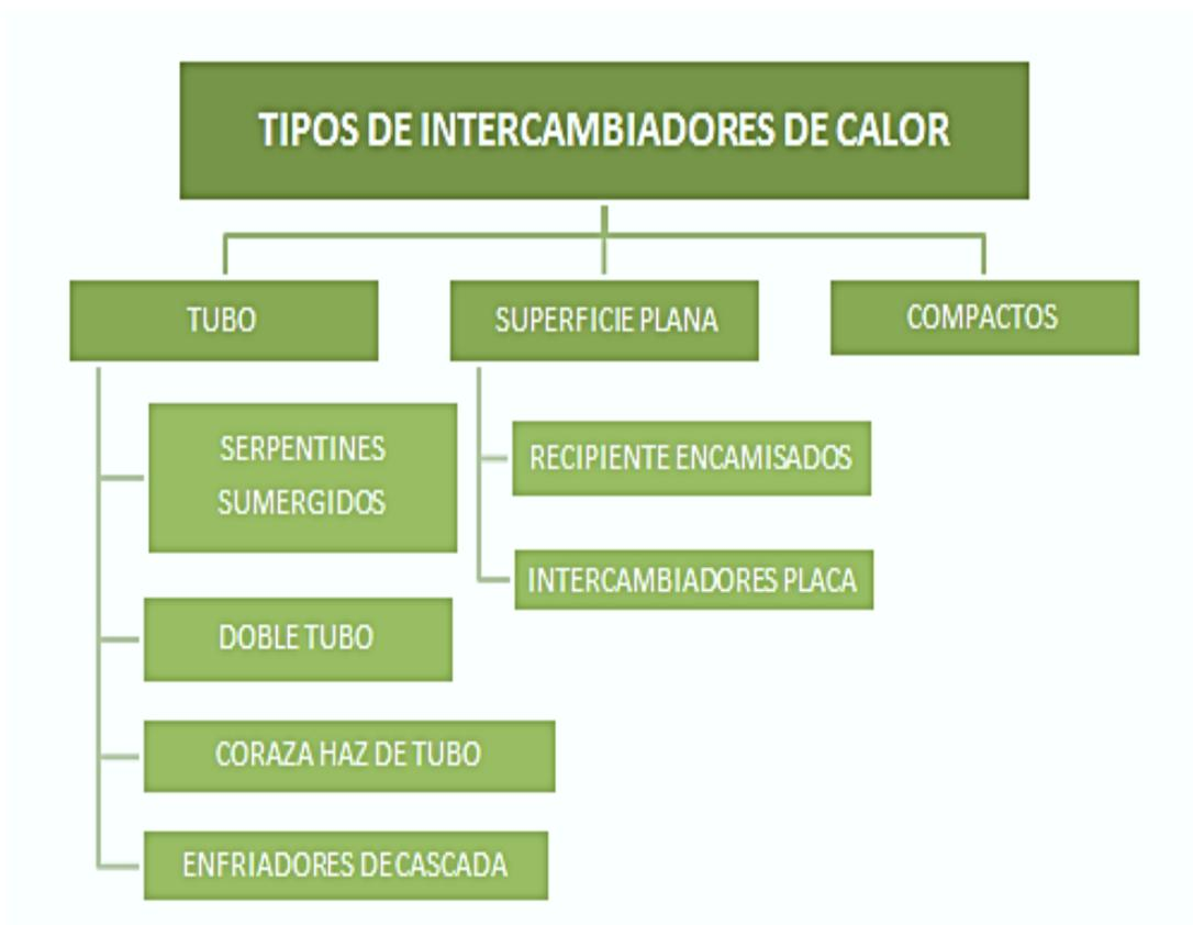
Diagrama 2.7. Clasificación de intercambiadores utilizada en la maquinaria de acería y laminación
