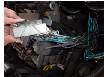
Fuente: Grupo de investigación Figura 2. Conexión del arnés de Megasquirt
