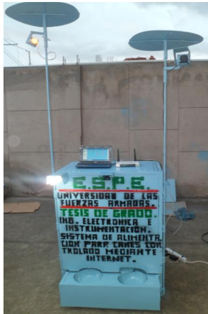
Figura 2.29: Estructura frontal del sistema de alimentación
