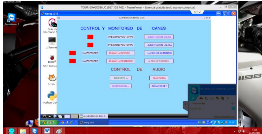
Figura 2.47: Ventana del proceso de Alimentación, observado desde el Internet por Acceso Remoto con TeamViewer.
