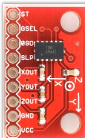
Figura 2.4: Distribución de pines del acelerómetro MMA7361L montado en la PCB.
