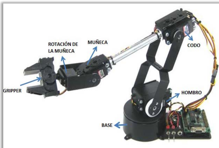
Figura 2.28: Brazo robótico Lynxmotion AL5D con sus articulaciones.
