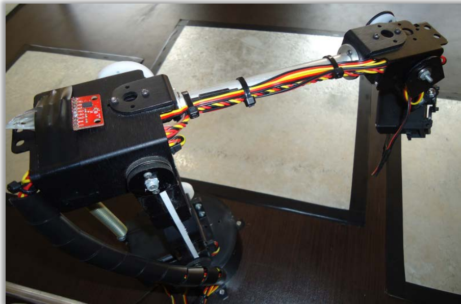
Figura 3.1: Acelerómetro sobre las articulaciones del codo del robot manipulador.
