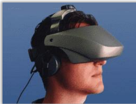
Figura 1.17: Casco de realimentación visual.
