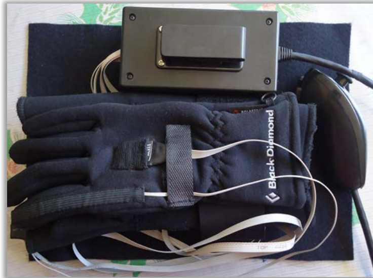
Figura 2.76: Hardware guante de datos.
