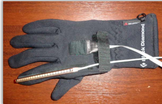
Figura 2.19: Ubicación del sensor flex sobre el guante.
