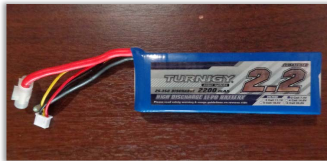
Figura 2.22: Fuente de alimentación de la placa PCI 1.
