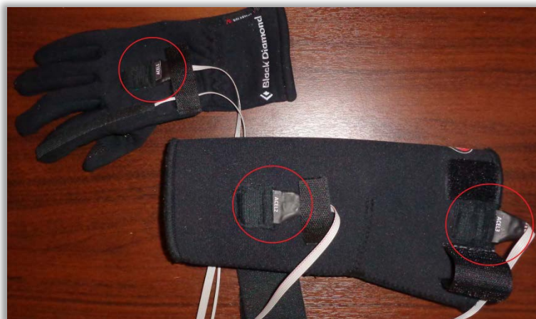
Figura 2.18: Acelerómetros montados sobre el dispositivo guante.
