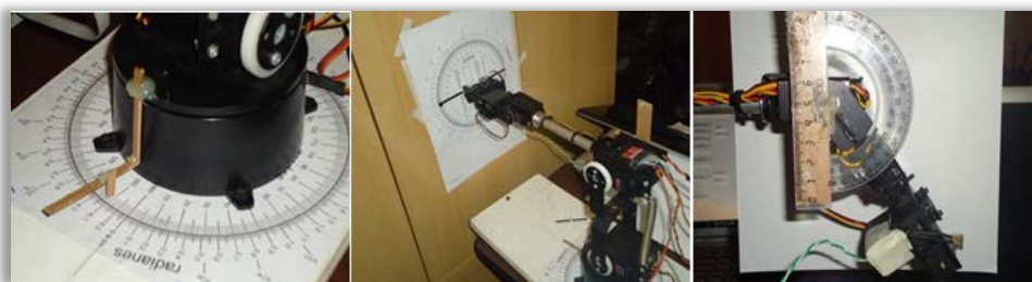
Figura 3.10: Medición del Ángulo Real del eje de cada actuador.
