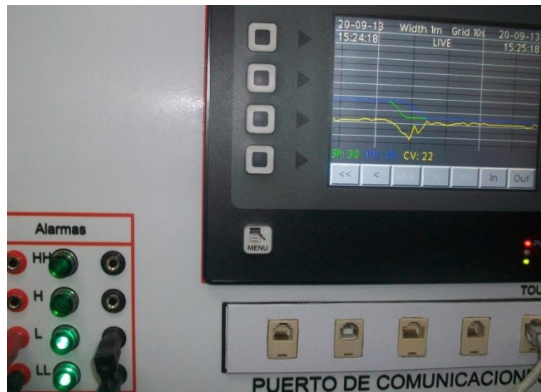
Figura 3. 28: Respuesta del sistema con un control PID más las alarmas
