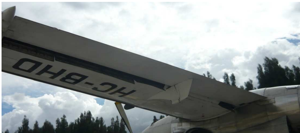
Figura 3.5: Borde de salida del ala izquierda con las tapas abiertas
