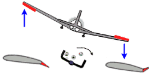
Figura 2.7: Funcionamiento de los Alerones
