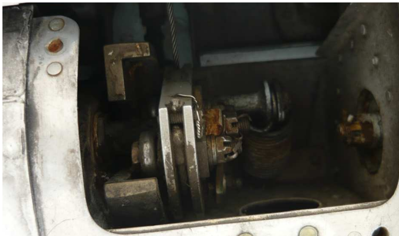
Figura 3.28: Varilla de doble efecto del balance tab
