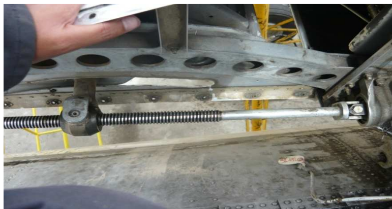
Figura 3.21: Conjunto de eje giratorio y spindle
