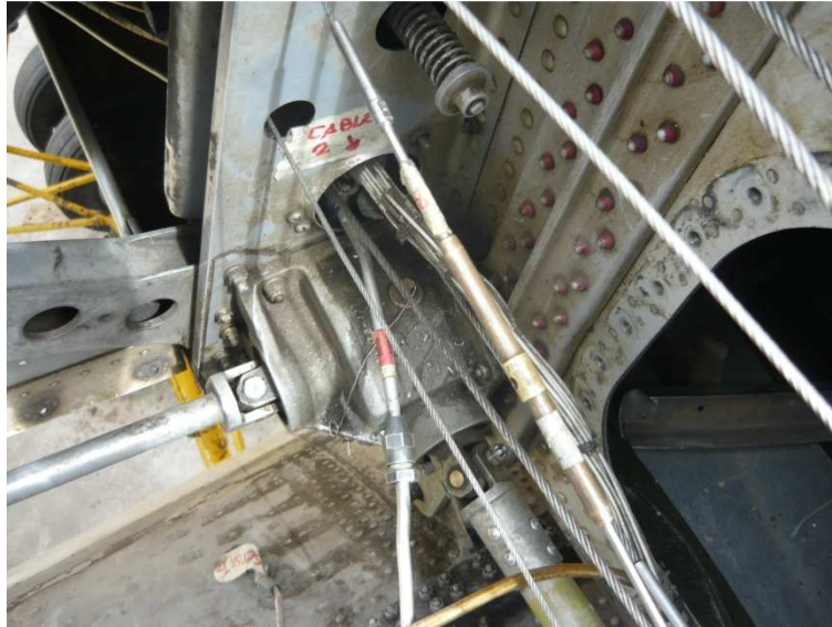
Figura 3.12: Cables de control en la parte posterior ala central
