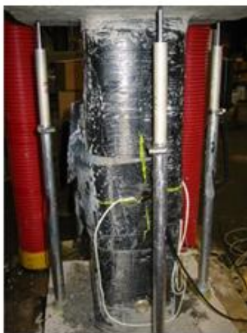
Figura 5.5 Ensayo a compresión de hormigón confinado con FRP
