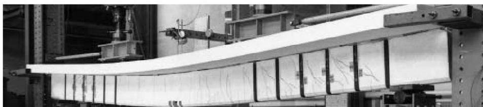
Después del ensayo a la falla
