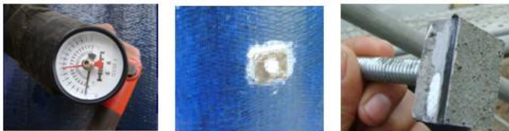
Figura 5.6 Ensayo de adherencia
