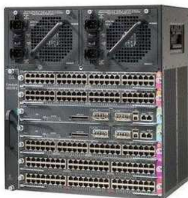
Figura. 2.4. Switch Core 4507R
