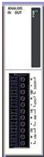
Fig. 3.2 Módulo de entradas y salidas analógicas. Realizado por: Javier Ortiz
