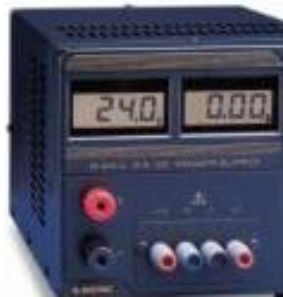
Fig. 3.3 Fuente de alimentación de 24VDC Elaborado por Javier Ortiz
