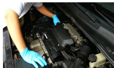
Gráfica 18 Comprobación de fugas de combustible en el sistema de inyección.
