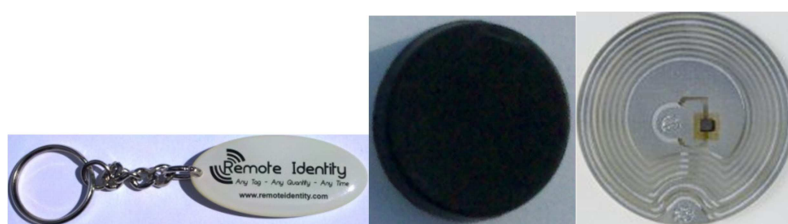
Figura. 2.4. Varios encapsulados de los etiquetas RFID de izquierda a derecha: a) llavero, b) botón para ropa y c) etiqueta para CD`s (Libera Networks, 2010)
