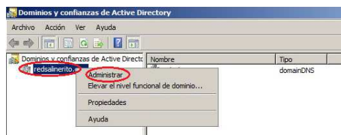
Figura 4. 61. Implementación de servidor de correo – Crear usuarios en Active Directory
