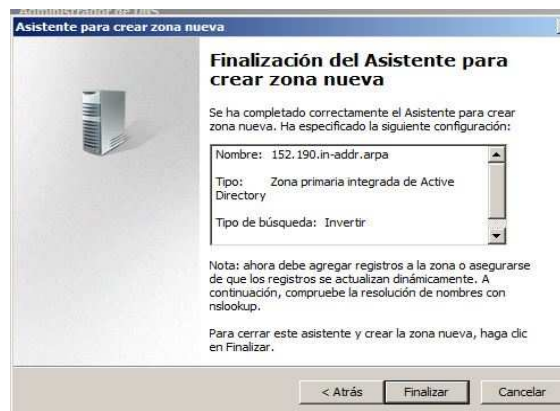
Figura 4. 35. Configuración del servidor DNS – Resumen de la instalación de zona de resolución inversa
