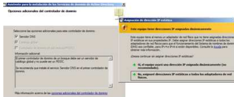
Figura 4. 23. Implementación de Active Directory – Opciones adicionales del controlador de dominio
