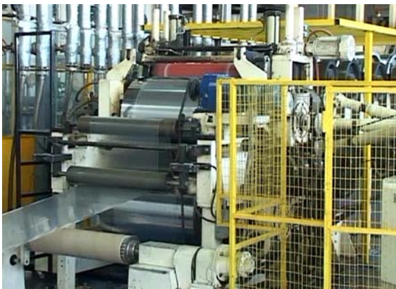
Figura 3. Estiramiento en dirección de máquina (MDO)
