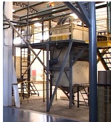
Figura 1. Mezclador principal planta de producción películas de polipropileno
