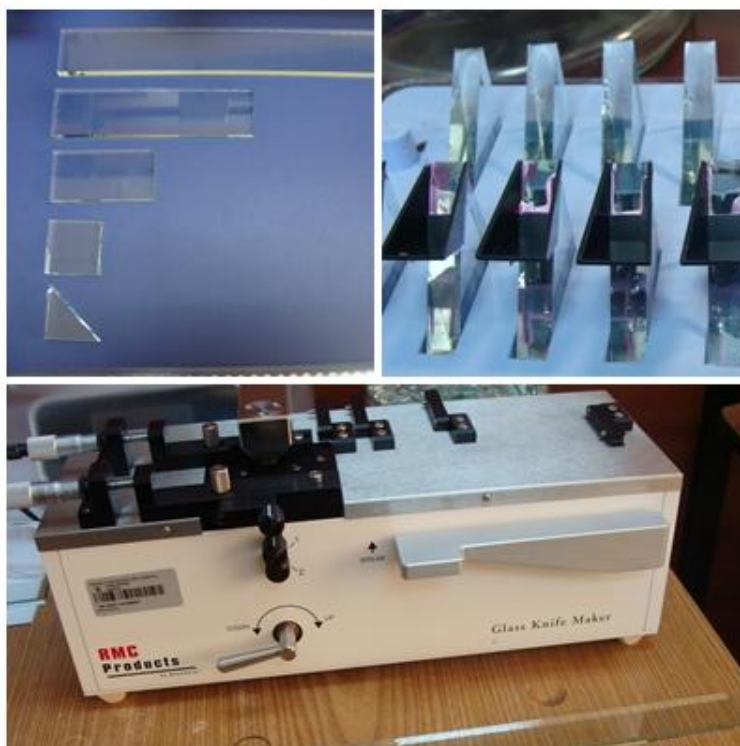
Figura 2.5: Obtención de cuchillas a partir de una barra de vidrio para microscopia
