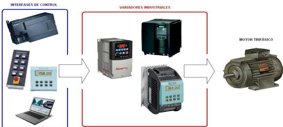
Figura 2.2. Variación de velocidad e interface de control
