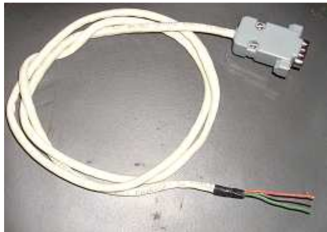
Foto2. Cable USS con terminación RS-485
