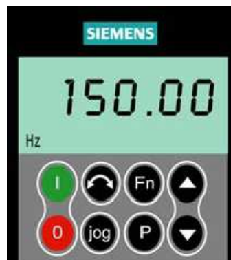
Figura 2.11. Panel BOP (Micromaster 440)
