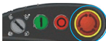
Figura 3.21: Paro de emergencia
