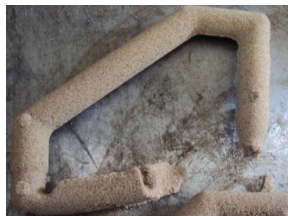
Figura 4-68 Noyos con rompimiento debido a falta de expulsor.
