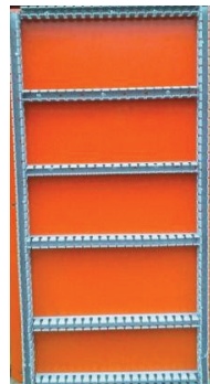
Figura 4-50 Montaje canaletas en tablero
