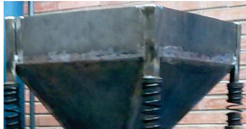
Figura 4-25 Montaje completo de la tolva de almacenamiento
