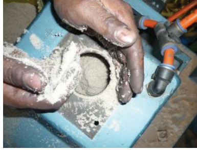
Figura 3-4 Ingreso manual de arena al bloque de soplado 32
