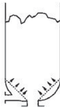
Figura 2-16 Cuadrícula cónica con fluido direccionado lateralmente 17
