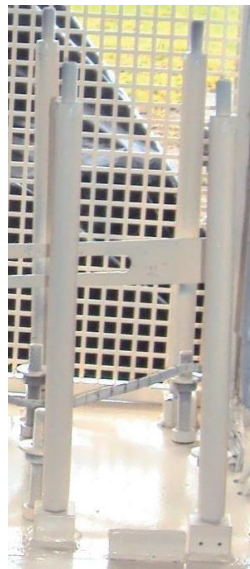
Figura 4-10 Tubos de soporte para pistón de sellado y carga de arena
