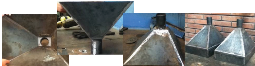
Figura 4-3 Tolva de almacenamiento finalizada
