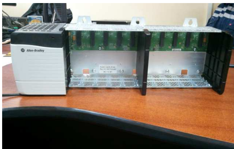
Figura 97. Fuente de alimentación Allen Bradley instalada en el chasis
