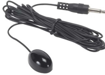
Figura 16: Cable Flasher IR (AVS)
