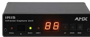
Figura 14: Grabador de infrarrojos IRIS (Whitlock)
