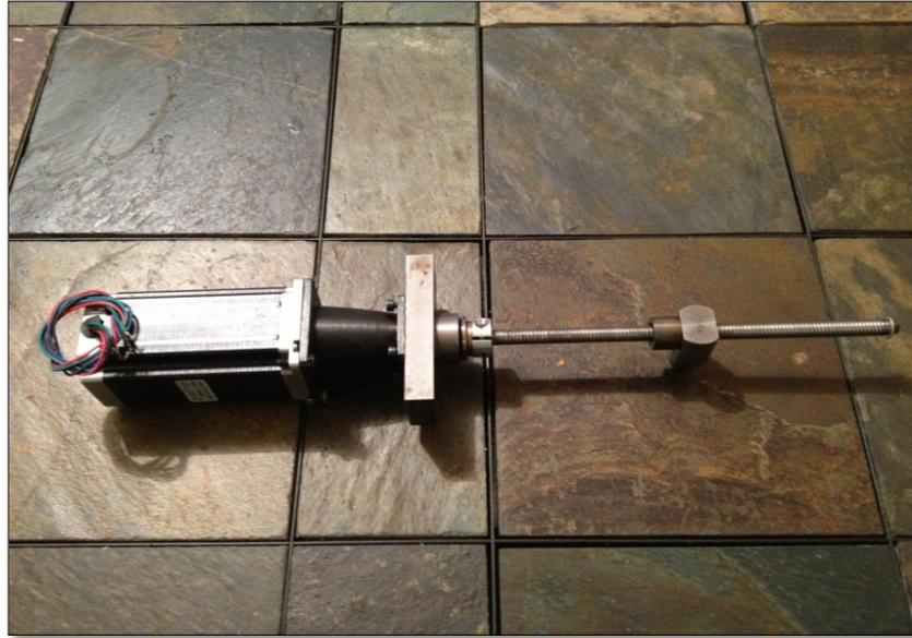
FIG 3. 21 Acople Motor- Soporte Eje Y
