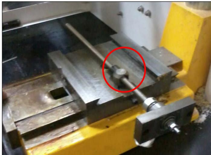
FIG 5. 14 Tornillo de bolas Eje X
