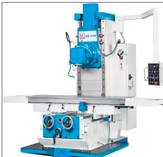
FIG 2. 11 Fresadora Vertical de 3 ejes.
