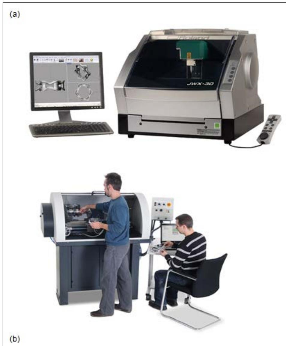
FIG 1. 3 (a) Fresadora CNC (b) Torno CNC (control numérico computarizado)
