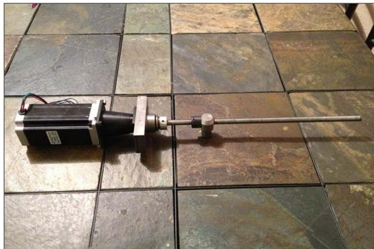
FIG 3. 20 Acople Motor- Soporte Eje X
