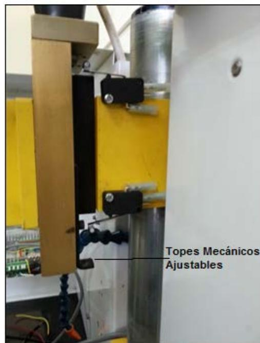
FIG 4. 16 Finales de Carrera Montados en la Máquina
