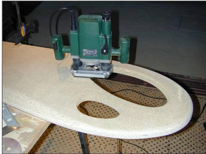
FIG 2. 10 Fresadora para Madera.
