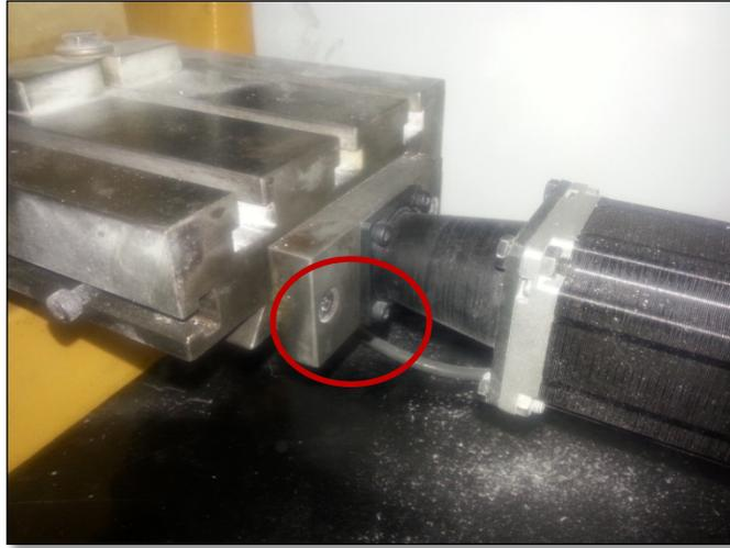
FIG 5. 13 Tornillos que sujetan el carro.
