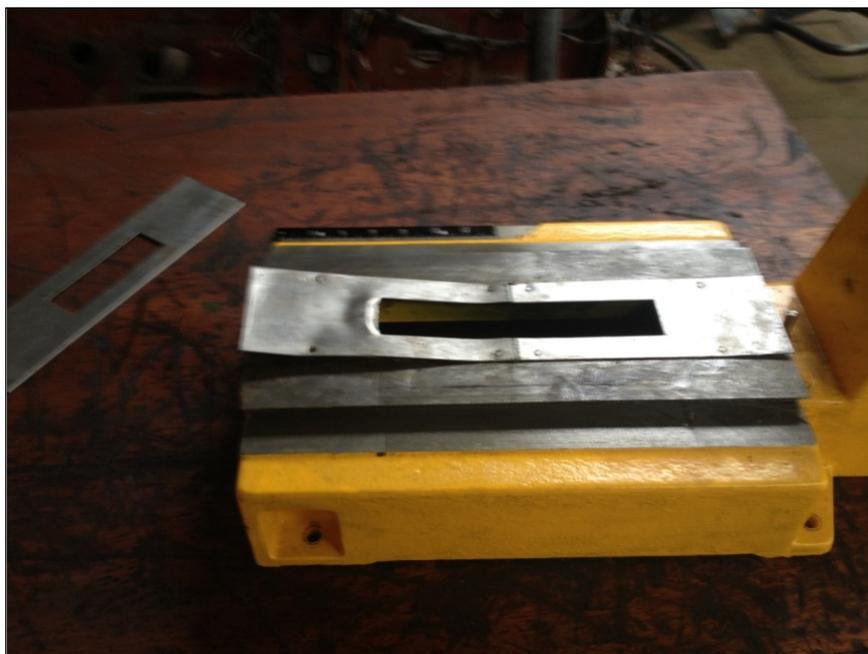
FIG 2. 50 Placa Deslizante averiada
