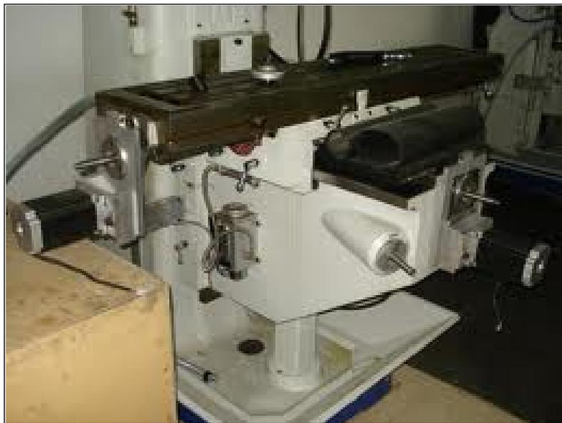
FIG 2. 21 Adaptación de Motores PAP a una fresadora Convencional
