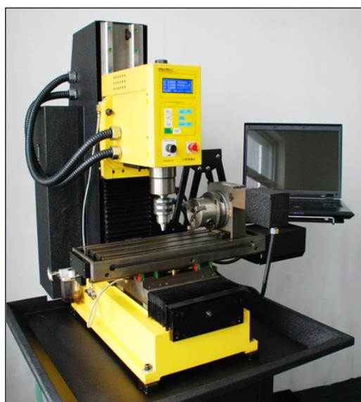
FIG 2. 12 Fresadora CNC conversión de 4 ejes con torno.
