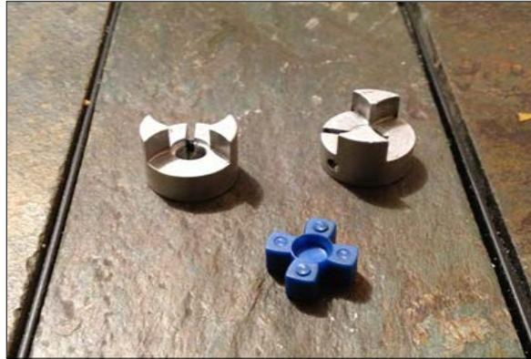
FIG 3. 19 Juego de Matrimonio para Motor y Tornillo de Potencia para cada eje
