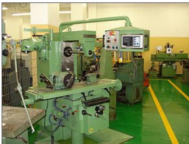
FIG 2. 1 Fresadora Universal con sus accesorios
