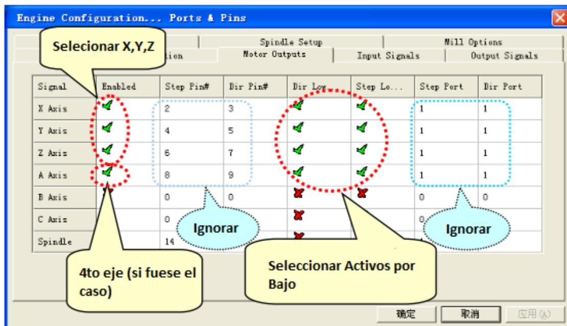
FIG 5. 22 Configuración de Salidas para Motores para Ejes X,Y,Z
