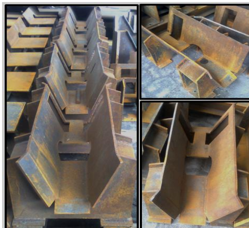
Gráfico N° 4.3: Construcción de cunas para camino de rodillos de entrada
