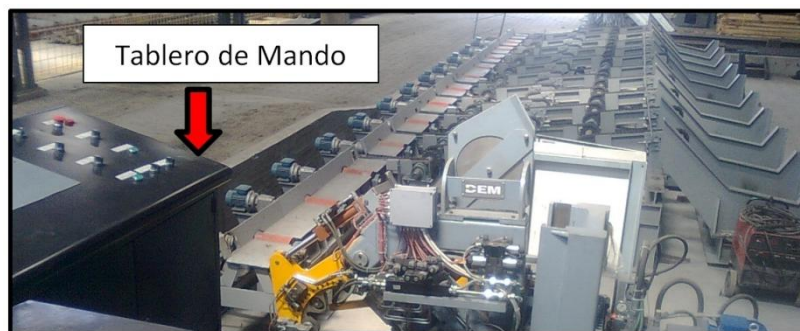
Gráfico N° 4.26: Tablero de control del proyecto
