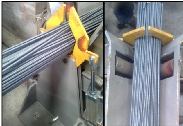
Gráfico N° 4.35: Funcionamiento apretador de varillas
