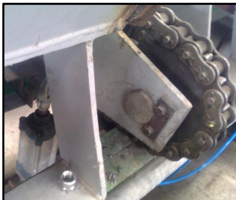
Gráfico N° 4.36: Funcionamiento pistones de transferidor
