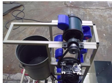
Figura 17 - Descarga de material abrasivo por fuerza centrífuga
