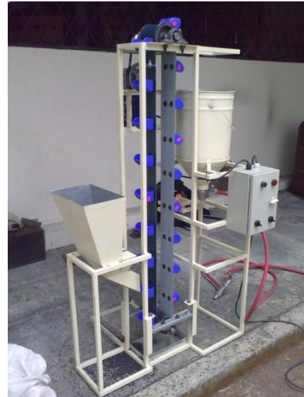
Figura 15 - Prototipo operativo-acople con manguera de aplicación
