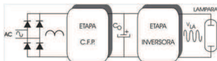
Figura 1.7: Etapas del balastro electrónico
