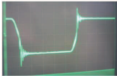
Figura 4.13: Efecto del tiempo muerto en la señal de voltaje al incrementar la frecuencia de operación.
