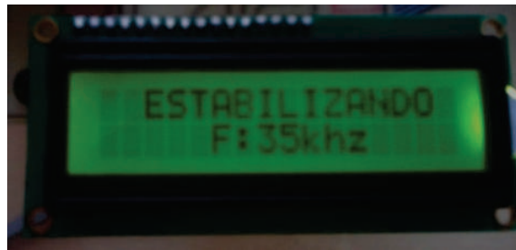
Figura 5.26: Mensaje que muestra el LCD mientras se estabiliza la lámpara a una frecuencia inicial de 35kHz.
