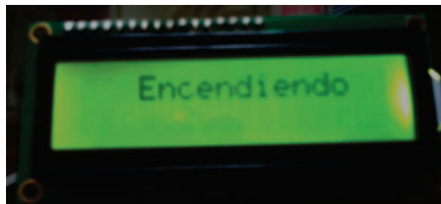
Figura 5.27: Mensaje que muestra el LCD en caso que la lámpara no se haya encendido
