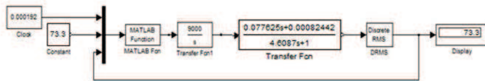
Figura 4.28: Sistema en lazo cerrado de la lámpara con set point de 73.3 \Omega
