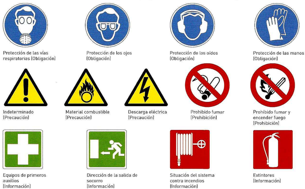
Cuadro 39: Señales internacionales de advertencia; Fuente: Seguridad y salud en el trabajo, Ing. Francisco Valencia; Elaborado por: Viviana Muete y Luis Guevara.
