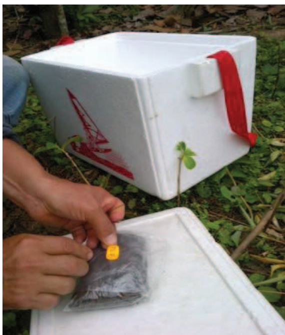
Figura 2. Etiquetado de las muestras de suelo
