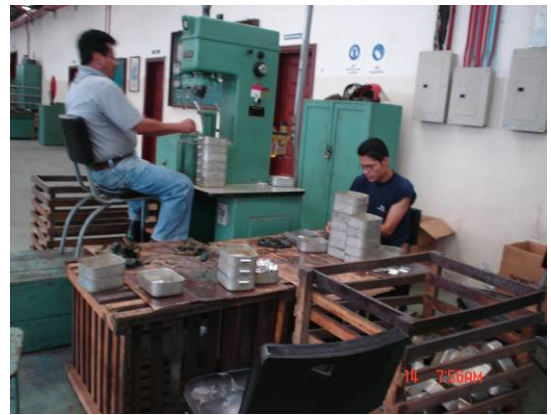
Los trabajadores no utilizan guantes o gafas de protección
