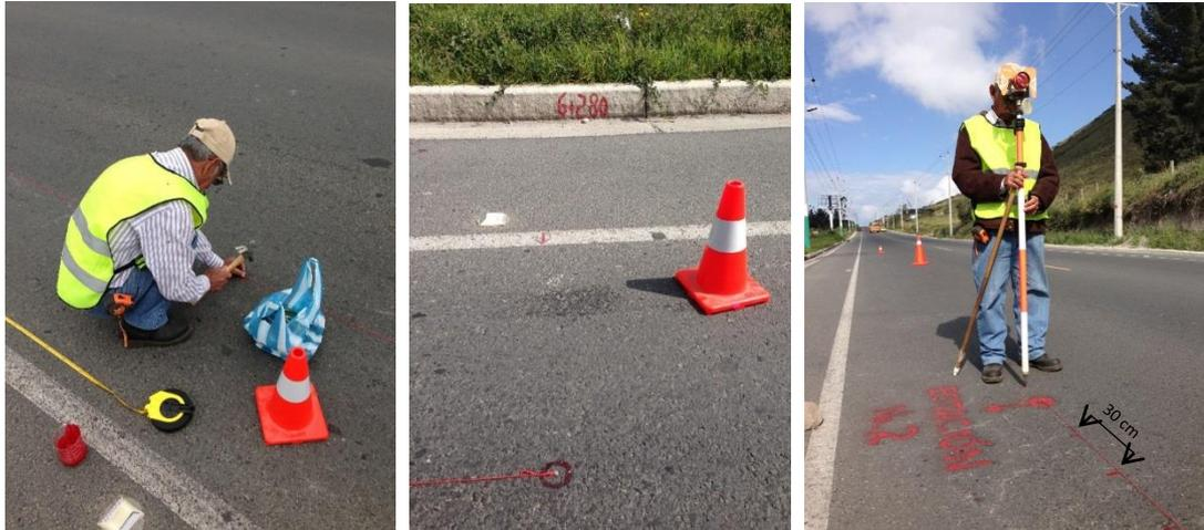
Con un flexómetro, se mide 1 metro desde la línea referencial derecha para que el levantamiento se realice en la huella derecha. Con el mismo GPS., se mide una distancia de 150 metros para poner el punto auxiliar No. 2, que además es la Estación No.1. Adicionalmente se utilizarán las Estaciones Nos 2 y 3 para realizar los 350 metros que indica la norma a un espaciamiento de 30 centímetros.
