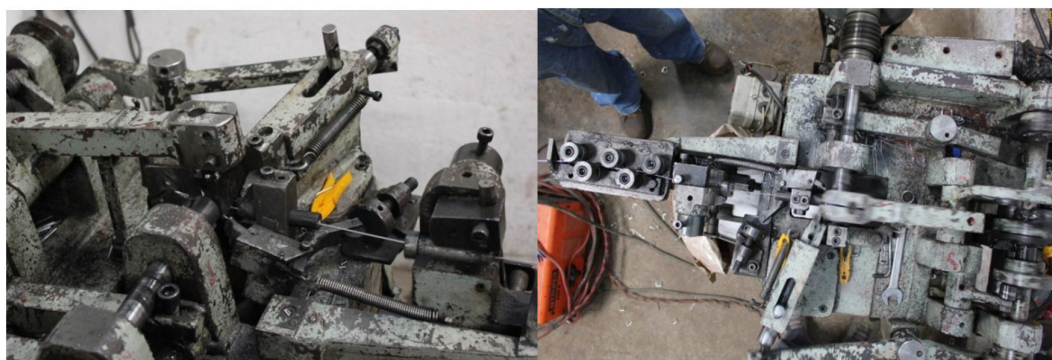
Figura 1.1. Máquina de Resortes de Pinzas para Ropa Mecánica.
