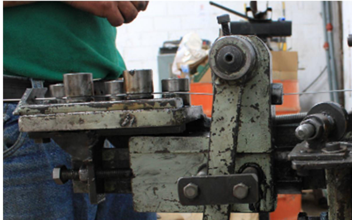
Figura 1.3. Enderezado y abastecimiento anti retorno de alambre.
