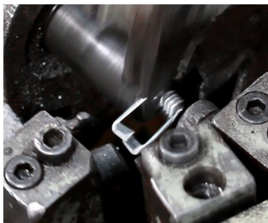
Figura 1.9. Doblado y cortado del brazo restante del resorte.
