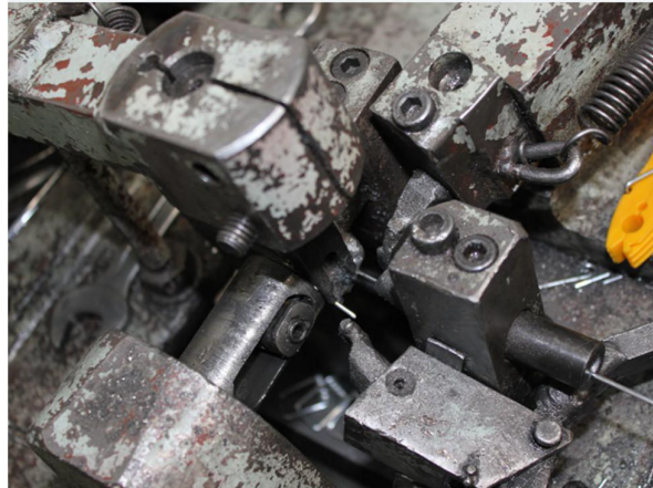
Figura 1.7. El punzón de los brazos del resorte baja para que éstos se formen.
