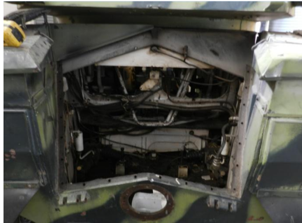
Figura 2 Compartimiento original para el motor a gasolina del PANHARD AML-90
