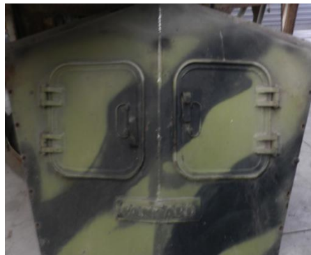
Figura 3. Puerta compartimiento del motor original del PANHARD AML-90
