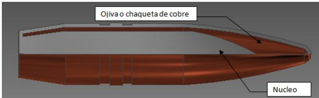
Figura 7.7 Calibre.50 Vista Lateral Corte Autodesk Inventor
