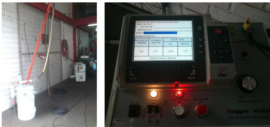
**Gráfico No. 65: Medición de la capacitancia del descargador.**
