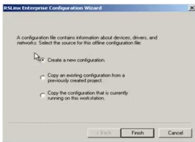
Figura 2.42: Configuración de la opción RSLinx Enterprise para establecer comunicación con medios físicos.
