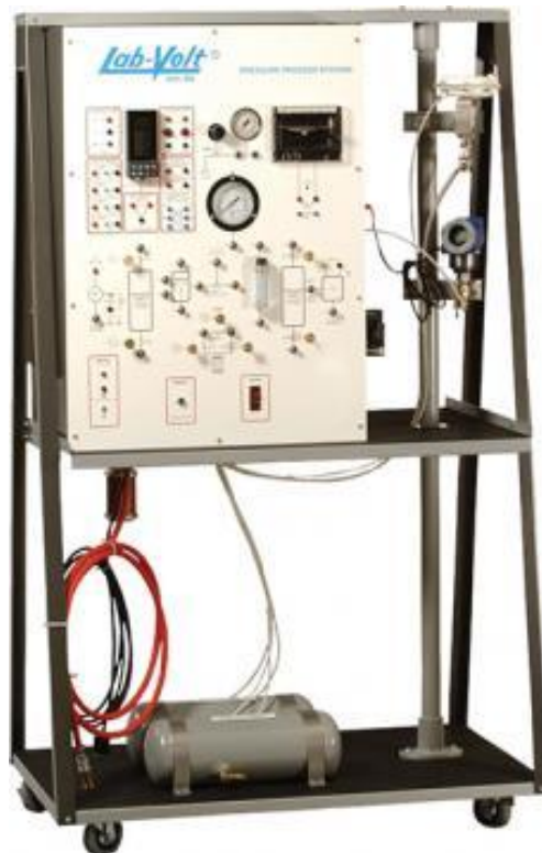
Figura 1.10: Estación de instrumentación del Proceso de Presión.
