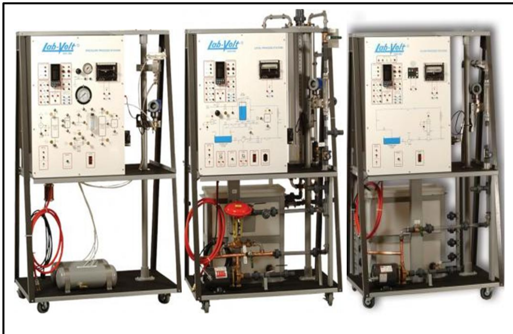
Figura 1.9: Estaciones de instrumentación y control de procesos.
