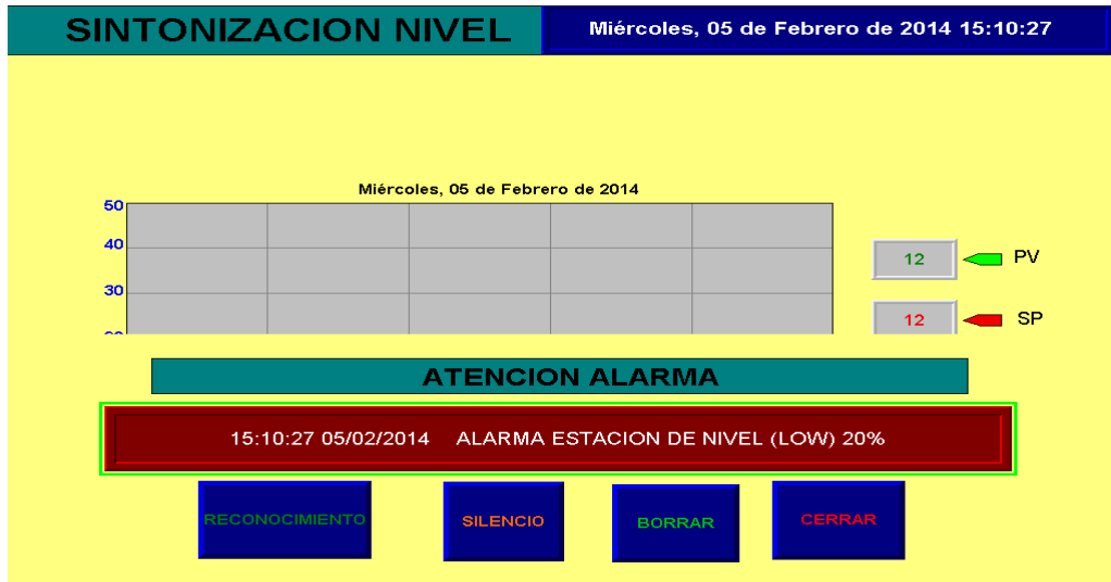
Figura 3.21: HMI – Alarma estación de Nivel (LOW).
