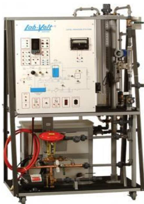
Figura 1.11: Estación de instrumentación del Proceso de Nivel.
