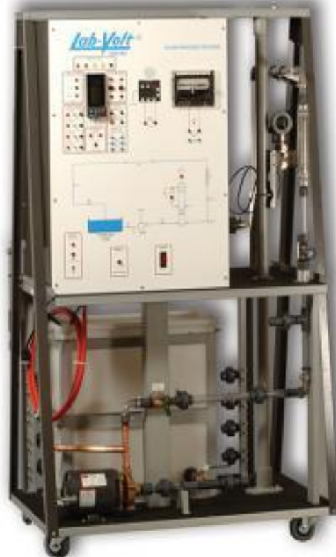
Figura 1.12: Estación de instrumentación del Proceso de Flujo.
