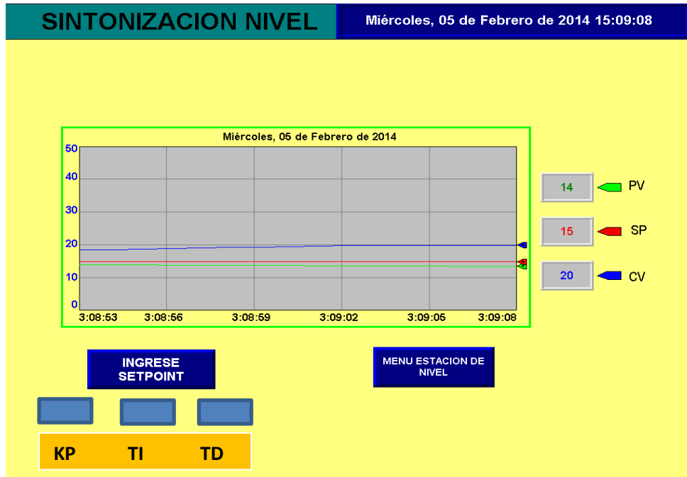
Figura 3.18: HMI – Sintonización estación de Nivel.
