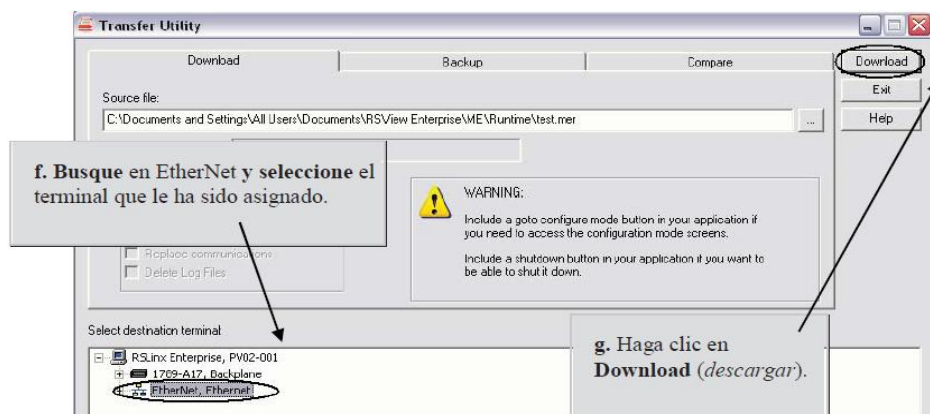
Figura 2.50: Ventana que muestra el proceso de descarga del archivo tipo Mer en el PanelView Plus 6/600.
