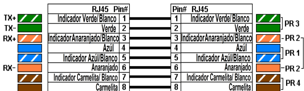
Figura 2.5: Cable de interconexión directa Ethernet.
