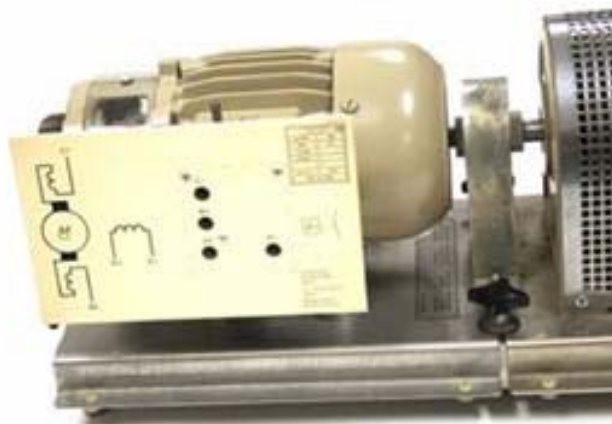
Figura 2.9. Motor de corriente continua con excitación derivación (shunt)
