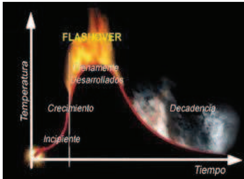
Figura 2.12 Fases de un incendio
