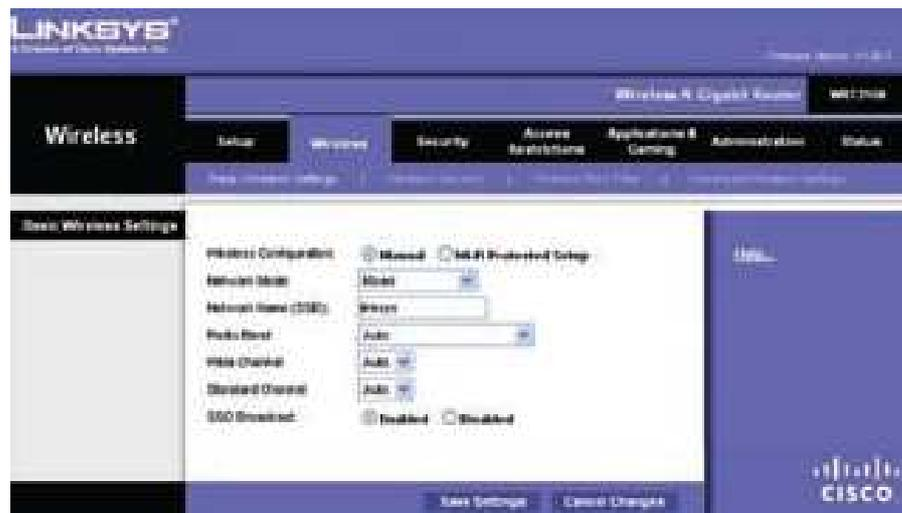
**Figura 3.16** Ventana de configuración manual del wireless
