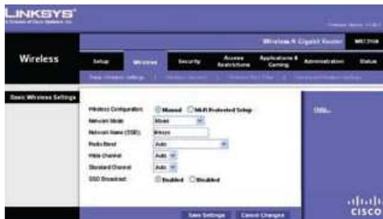
**Figura 3.15** Ventana de configuración básica del Wireless
