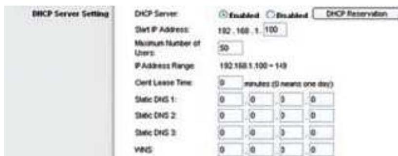
**Figura 3.11** Ventana de configuración de Servidor DHCP
