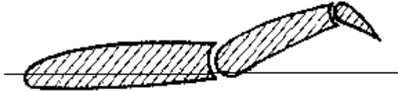
Figura 1.4. Ubicación de la aleta compensadora en el ala
