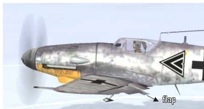
Figura 1.6. Con los Flaps en posición media. Se conocen por Flaps de despegue o takeoff.
