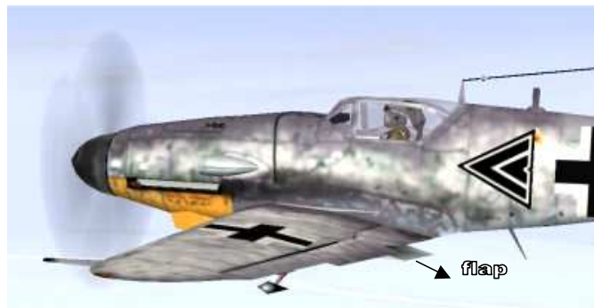
Figura 1.5. Con los Flaps ligeramente desplegados. Se conocen por Flaps de combate.
