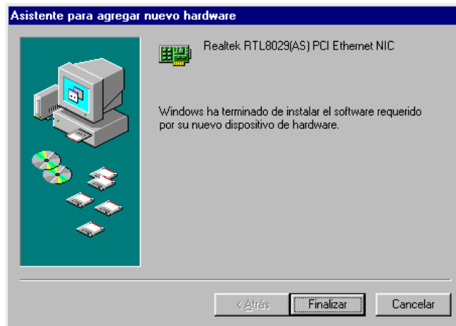
Figura 4.17. Finalización de la instalación del controlador
