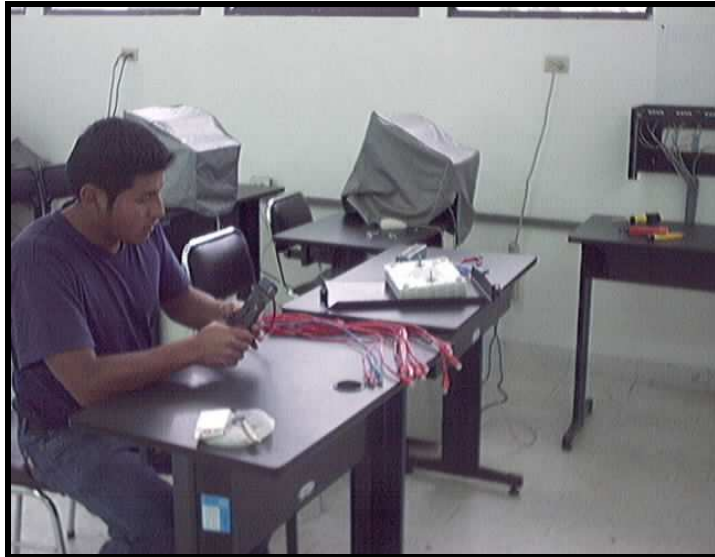
Figura A.6. Construcción de los patch cord
