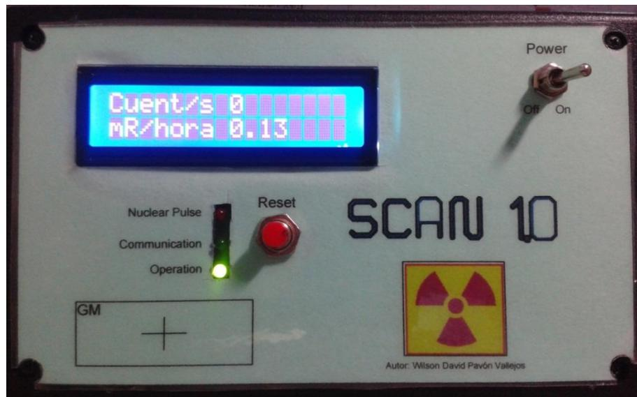
**Figura. 85. Cara frontal del Detector de Radiación**
