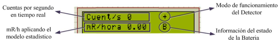
**Figura. 51. Diseño de la disposición de la información en el LCD**
