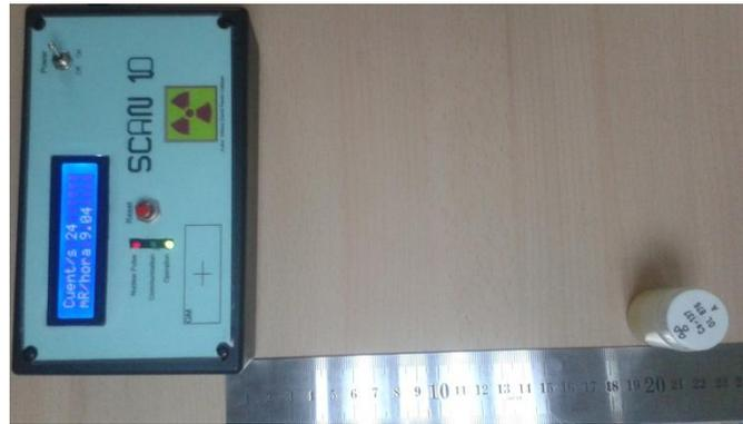
**Figura. 104. Primera prueba de validación del Detector de Radiación**
