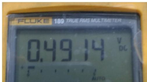
**Figura. 88. Medición de la salida de la fuente de Alto Voltaje de Corriente directa con una punta de alto voltaje con atenuación de 1000**
