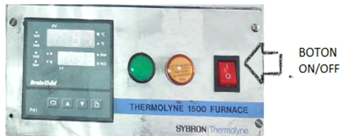
Figura 54. Encendido del sistema de control
