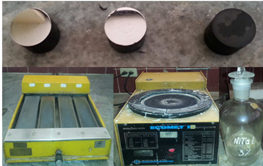
Figura 48. Procedimiento de pulimiento de probetas
