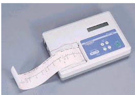
Figura 5.8: Electrocardiógrafo Danatech Vista 310
