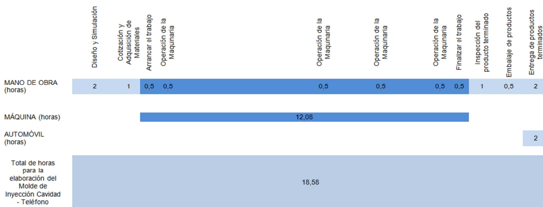
Figura 33. Cálculo del número total de horas para la elaboración del Molde de Inyección Cavidad – Teléfono.
