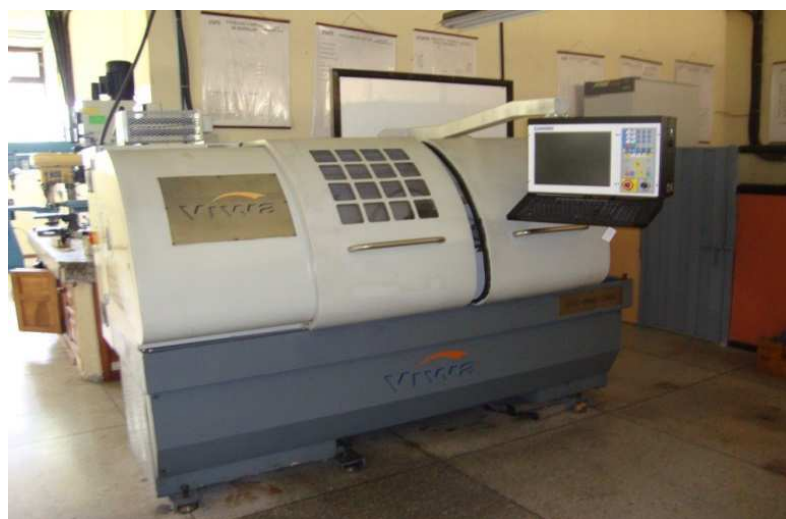
Figura 2. Torno VIWA VTC 1640-T400 del Laboratorio de Procesos de Manufactura del DECEM.
